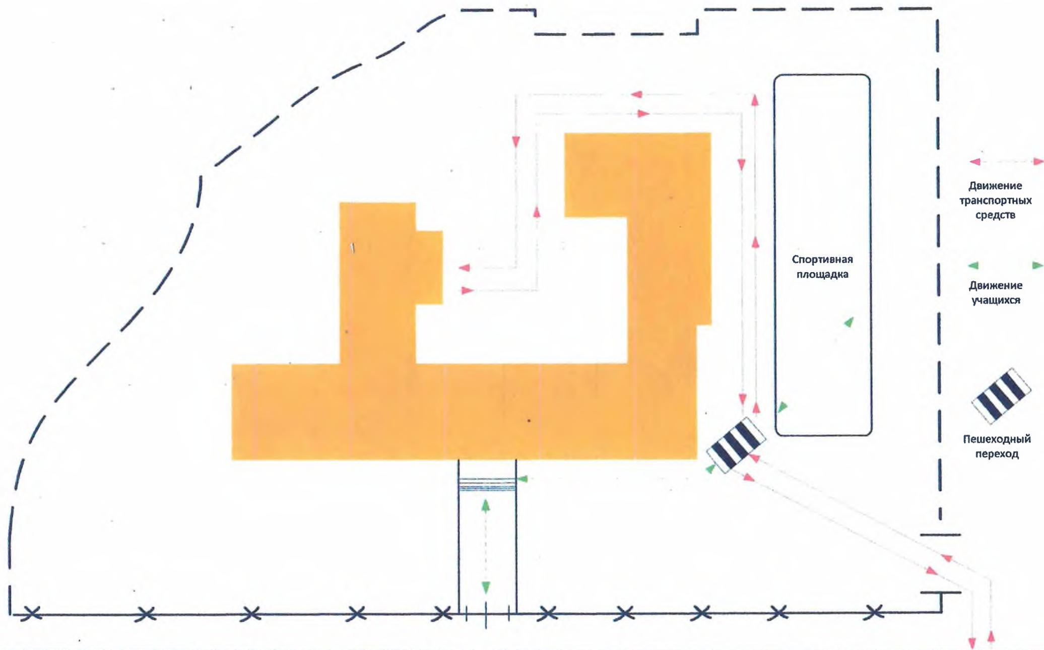
Типовая схема организации дорожного движения на нерегулируемом пешеходном переходе в непосредственной близости от образовательного учреждения при двухполосном движении транспортных средств.
